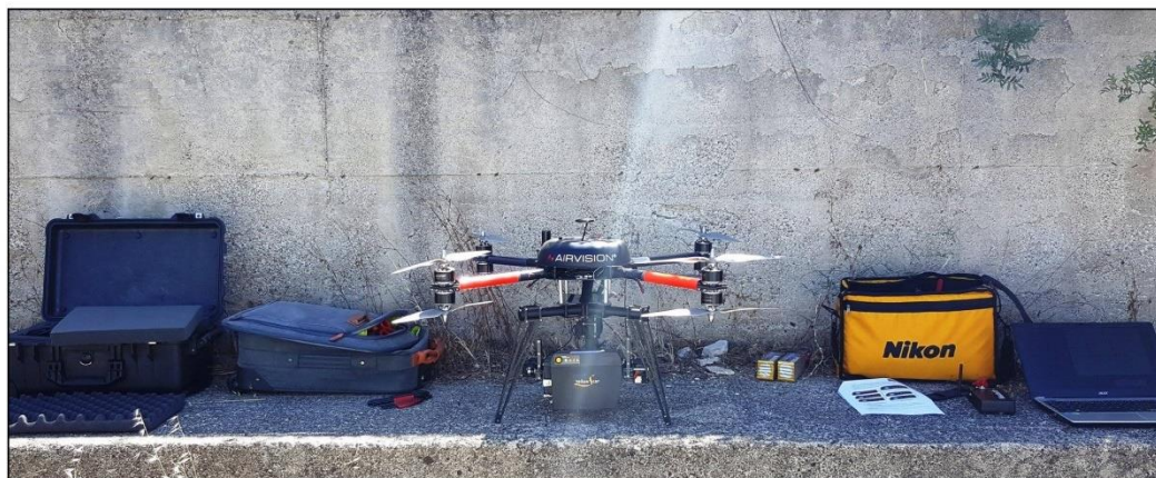
UAV tipo NT 8C con sistema LIDAR
